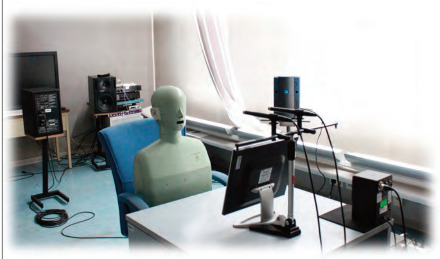
Figura 5: Set-up sperimentale per la simulazione di una comunicazione viva-voce con rumore e interferenti audio.
