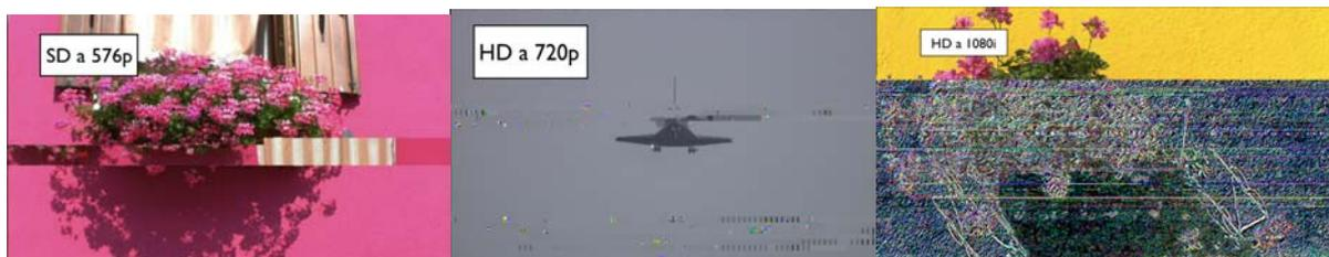
Fig. 6: Immagini da filmati video (SD, HD 720p e HD 1080i da sinistra a destra) durante un processo di ripristino MPLS LP+SSP. La degradazione avveniva per un tempo brevissimo (meno di 1 secondo).
