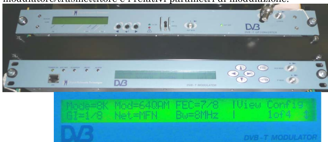
Figura 6.4: Sistema di trasmissione sul Ch 24 UHF e parametri di modulazione
