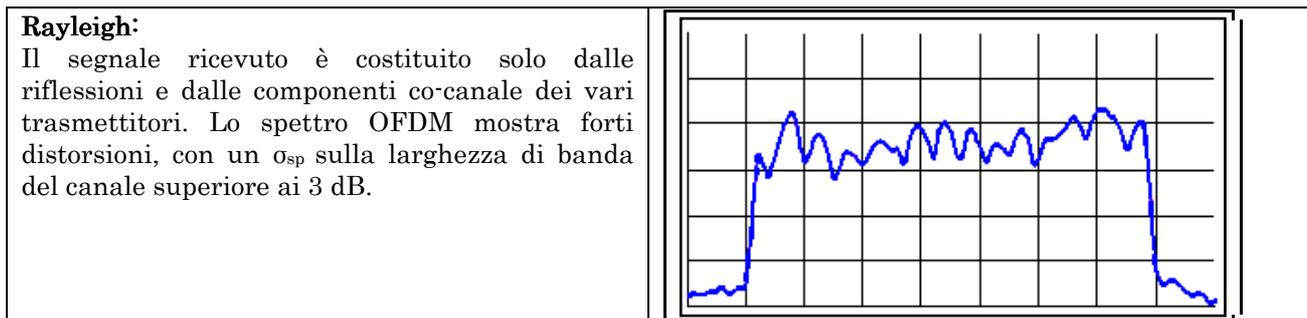
Figura 1-4: Classificazione dei canali di trasmissione
