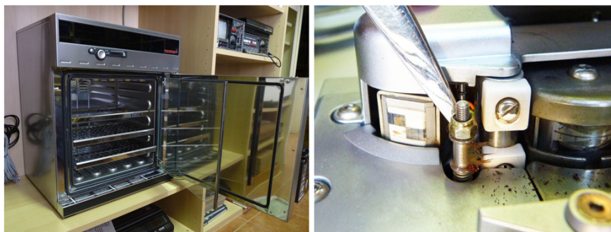
Figura 5: A sinistra, incubatore per il trattamento termico dei nastri magnetici; a destra, residuo di pasta magnetica depositato sul magnetofono dopo la lettura di un nastro che manifesta una perdita di pasta magnetica ( Sticky-Shed Syndrome , SSS).
