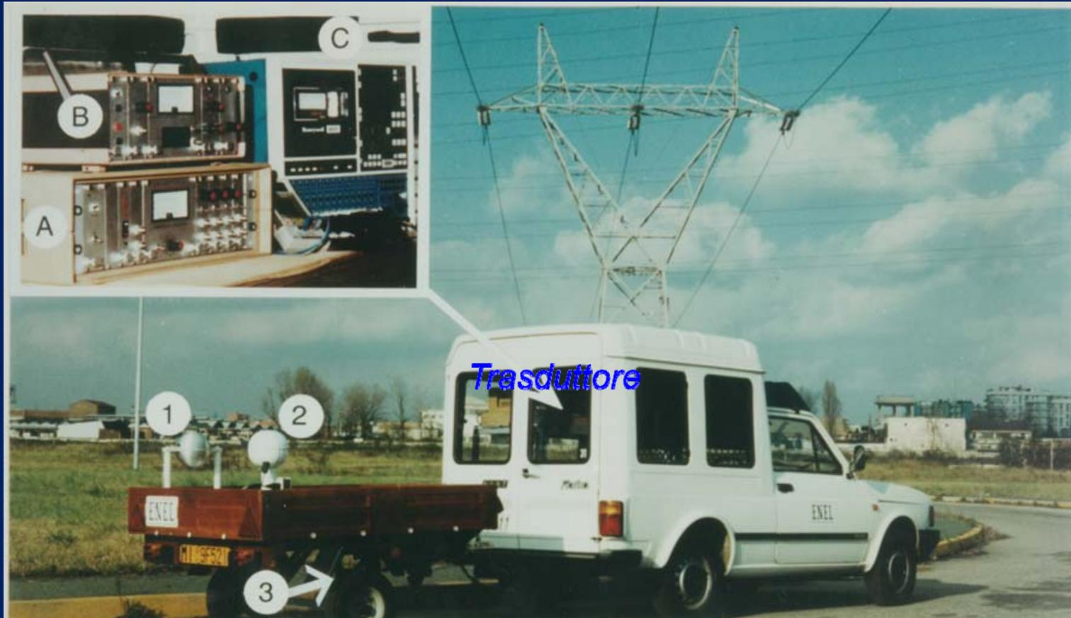
Unità mobile per la misura di campi E e B (50 Hz) progettata e realizzata dal Centro Ricerca Elettrica dell'ENEL: 1 Sonda E; 2 Sonda B; 3 Trasduttore per la misura della distanza; A,B Filtro, amplificatore, convertitore analogico digitale; C Registratore analogico (a nastro magnetico).
